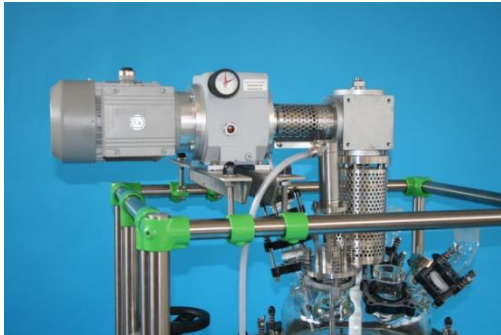
Antriebs Anordnung / Mixing gear situation
