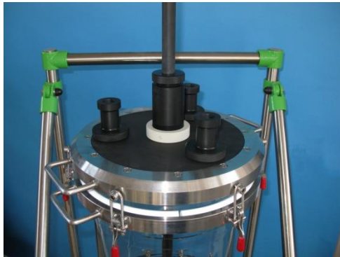
Deckel mit Stutzen / Cover with nozzles
