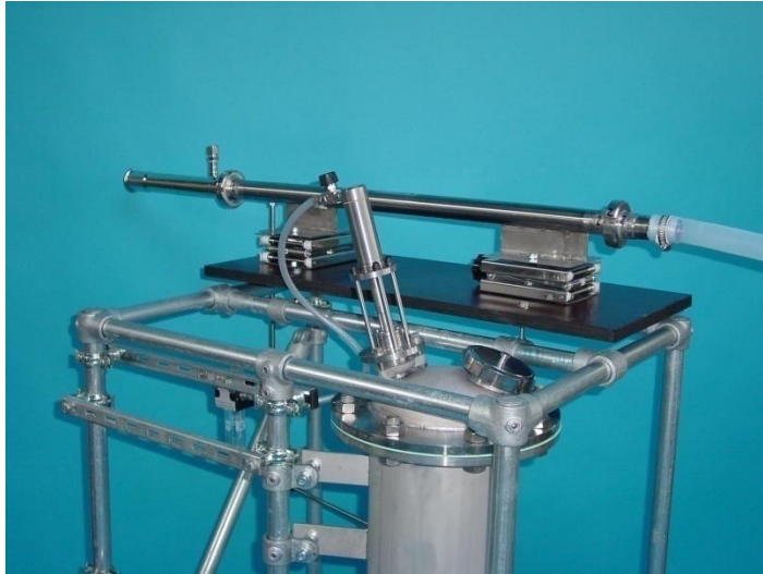
STATIK-Mischer-Rohr / Static-mixer -pipe
