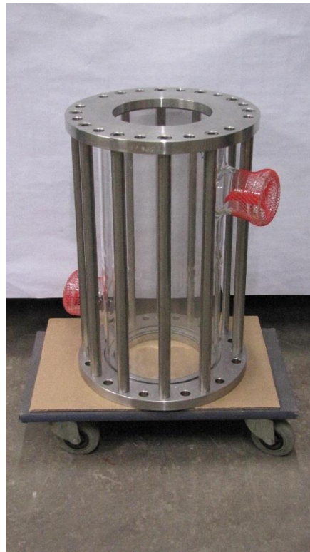
Koaleszenz-Abscheider DN 300 / BSG 3.3/1.4571 (1-/ +1bar – 80°C)
