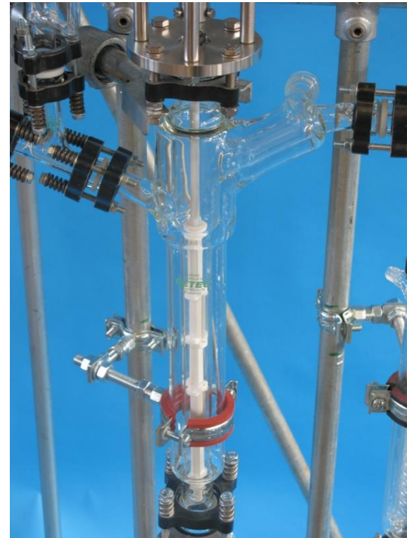
Dünnschicht Verdampfer/ Thinfilm evaporator /Wiper
