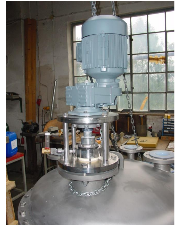
Getr.-Motor m. einfachwirk. GRD Gear Motor with singel mech. seal
