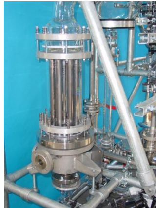
Heizkerze f. CUV/ Heater candle - Tantalum -
