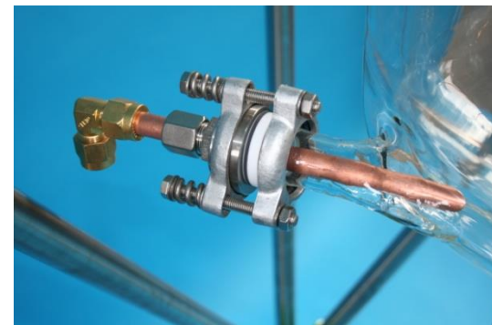
Zulauf Heizmedium / Inlet heating medium
