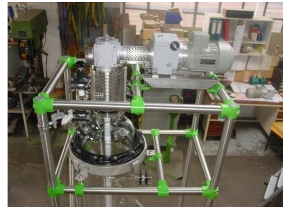
Antriebs Anordnung / Mixing gear situation
