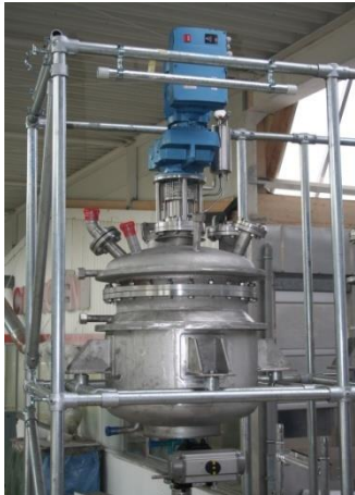
Schmelzkessel/ Melting vessel
