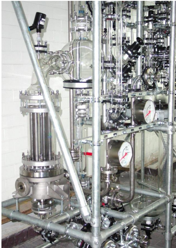
Verdampfer 0,2m 2 (Tantal)/ Evaporator 0,2m 2
