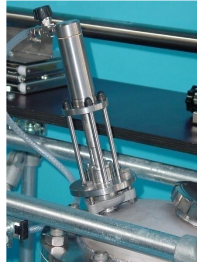
Druckluftrührer / Air pressure mixer
