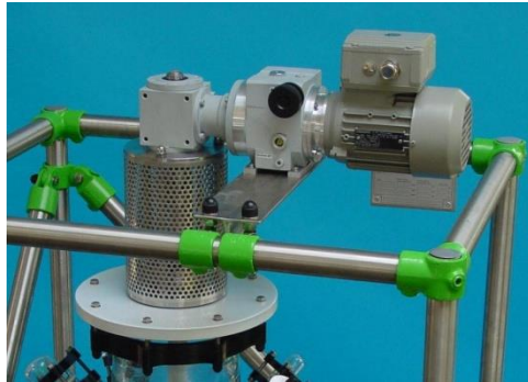
Getr.-Motor (waager.) + GRD Gear Motor (horic.) w. mech. seal
