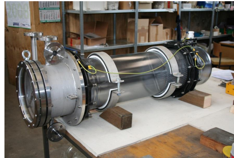
Koaleszenz-Abscheider DN 300 / BSG 3.3/1.4571 (1-/ +1bar – 80°C)
