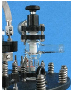
Zulauf-Ventil DN 25/ GL32 / Inlet valve
