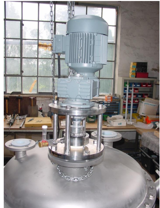
Rührantrieb + Gleitringdichtung/ Motor gear + mechanical seal
