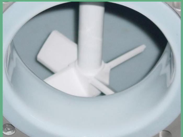
Behälter mit 4 mm ETFE Beschichtung
