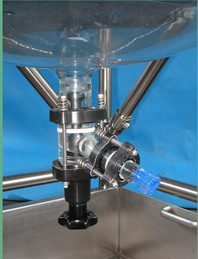
Bodenablassventil DN 50
