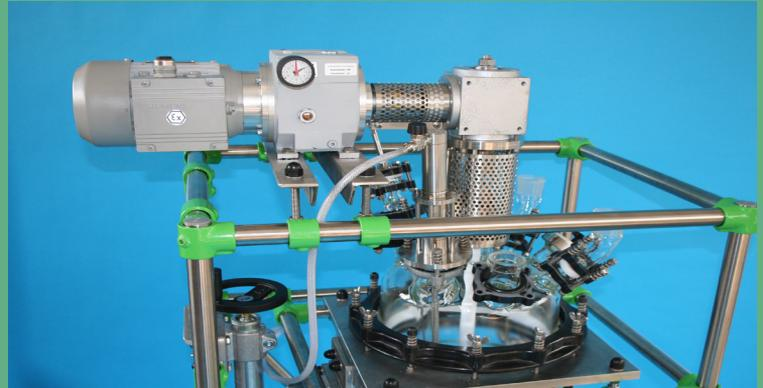
E-Rührwerk + Druckluft-Rührwerk
